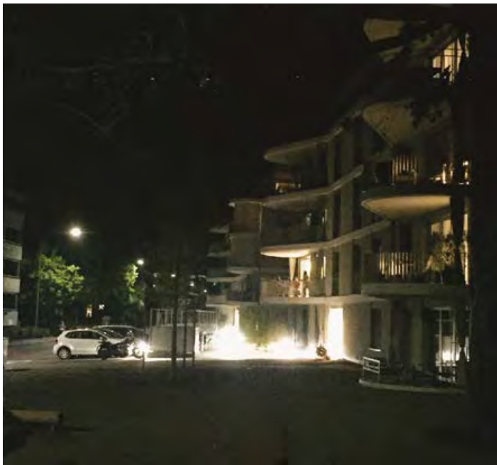
Negativbeispiel: Unnötige seitliche Abstrahlung in alle Richtungen, diese schlecht abgeschirmten Leuchten können blenden und ablenken, MFH-Neubau Birsfelden
